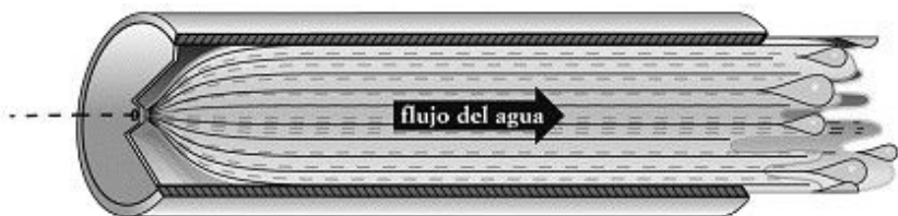
FIGURA 23. El agua que entra en una manguera a través de un orificio de su boquilla se expande primero en tres dimensiones antes de trasladarse sólo a lo largo de la única dimensión larga de la manguera.
