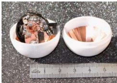
Una de las «pelotas de ping-pong» equipadas con un radiotransmisor que se introdujeron en el tubo del haz del LHC para comprobar si había alguna obstrucción.
