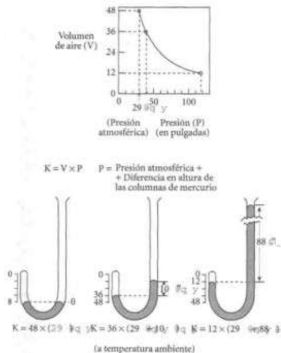
*Figura 4. La ley de Boyle, que estableció la relación de proporcionalidad inversa entre la presión y el volumen de un gas a temperatura constante, deriva del experimento ilustrado. El mercurio vertido en la rama larga del tubo empuja el aire encerrado hacia la rama corta. Doblando la altura de la columna de mercurio, la de aire se reduce a la mitad. La relación viene expresada en la curva de la parte superior, que es una sección de una rama de hipérbola.*
