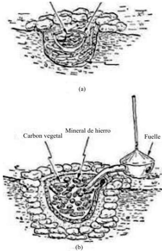
*Figura 1. Crisoles primitivos ideados para alcanzar la temperatura adecuada para la reducción de los diferentes minerales. En el horno para cobre (a) la mena fundía en un crisol sobre fuego de leña. La reducción del mineral de hierro (b) requería más calor, y para obtenerlo se llenaba el horno de carbón vegetal, suministrando oxígeno mediante un fuelle.*
