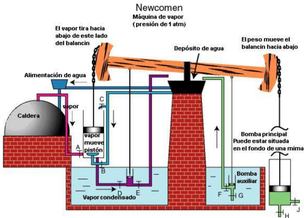
*Figura 5. La máquina de bombeo de Newcomen, que funciona a presión atmosférica. El agua pulverizada en el interior del cilindro condensa el vapor, creando un vacío. El pistón desciende en el vacío, para volver hasta arriba del émbolo por una nueva inyección de vapor.*
