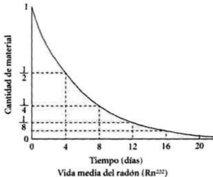
*Figura 22. La vida media del radón se determina midiendo las cantidades de material que quedan al cabo de intervalos de tiempo iguales. La representación es la curva exponencial asintótica,  $y = e^{-ax}$*
