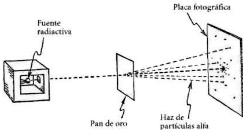
*Figura 23. El experimento de Rutherford condujo al concepto de núcleo, y abrió las puertas a la moderna física nuclear. Las partículas alfa emitidas por la fuente radiactiva se desviaban al pasar a través de un pan de oro. El grado de desviación quedaba registrado cuando las partículas chocaban con la placa fotográfica.*
