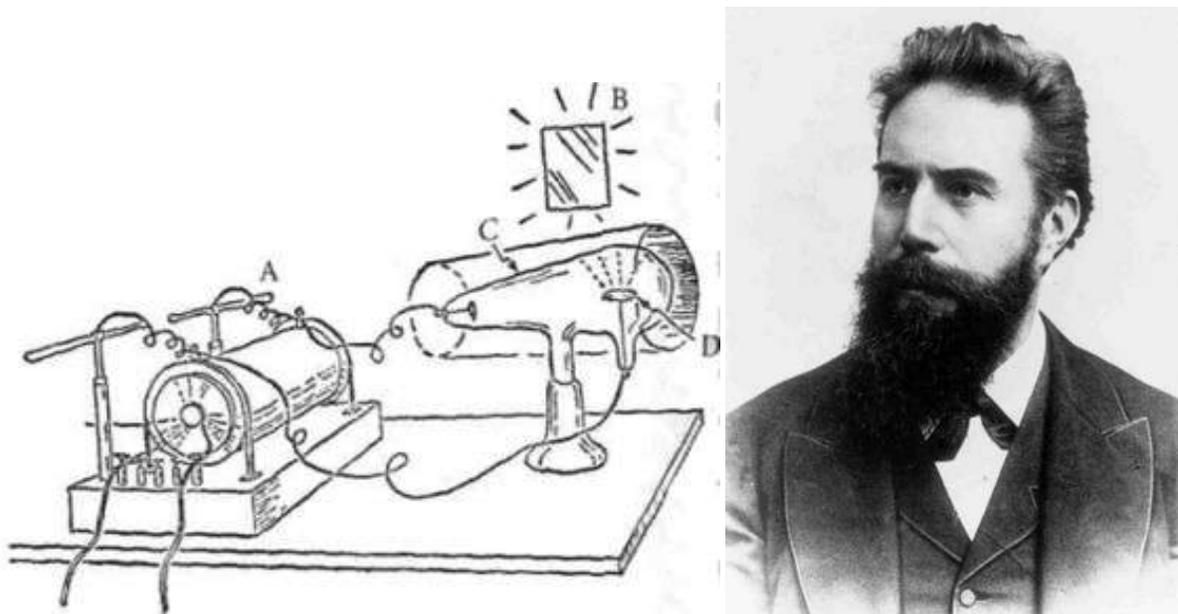
*Figura 21. El aparato de rayos X utilizado por Roentgen consistía en: (A) bobina inductora de alto voltaje; (B) papel pintado con platino-cianuro bórico, que resplandecía al ser alcanzado por los rayos; (C) tubo rodeado por una envoltura cilíndrica de cartón negro; (D) el cátodo, que emitía electrones. Derecha, Wilhelm Konrad Roentgen*
