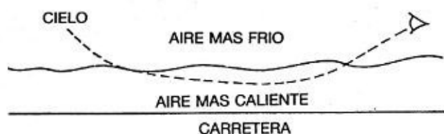
FIGURA 31. Encontrar el camino de tiempo mínimo explica como se produce un espejismo. La luz viaja más deprisa en aire caliente que en aire frío. Parte del cielo parece estar en la carretera porque parte de la luz del cielo llega al ojo proveniente de la carretera. La única ocasión en la que el cielo parece estar en la carretera es cuando lo refleja el agua y así el espejismo hace que parezca que haya agua.
