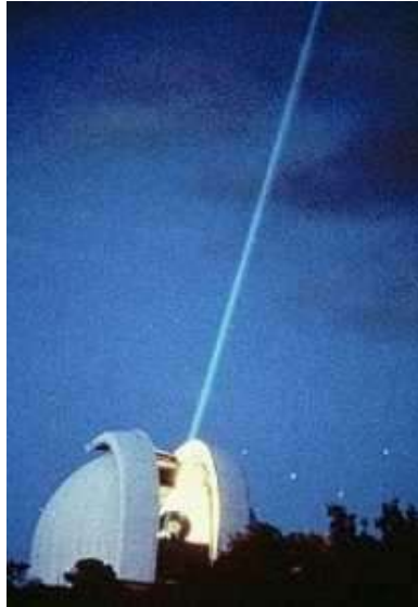
Rayo láser dirigido a los retrorreflectores situados en la superficie lunar. El telescopio es el reflector de 82 pulgadas del observatorio McDonald, Universidad de Texas.
