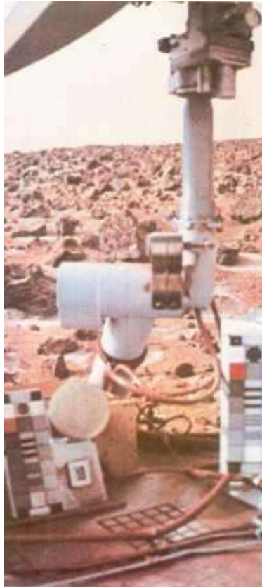
Figura 104 a Escarcha en Utopía. Una fina capa de escarcha de agua helada cubre el suelo a 440 de latitud norte en Marte, en octubre de 1977, al comienzo del invierno boreal. La estructura vertical sostiene la antena de alta ganancia para la comunicación directa del Viking 2 con la Tierra. Los cuadros coloreados y las rayas negras sirven para calibrar las cámaras. El cuadrado negro de bordes blancos; abajo a la izquierda, es un micro punto en el cual están escritas —en pequeño— las firmas de diez mil personas encargadas del diseño, fabricación, comprobación, lanzamiento y control de misión de la nave espacial Viking. Los humanos se han convertido, casi sin darse cuenta, en una especie multiplanetaria. (Cedida por la NASA.)
