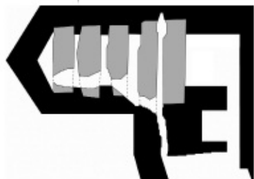
Figura 23.2. Grafitos de obreros en los muros norte, sur y oeste de la penúltima de las cámaras de descarga de la pirámide de Khufu (llamada de lady Arbutnot). A) Marcas de nivel horizontal, a 59,60 metros de altura respecto a la base. B) Marca del eje norte-sur de la pirámide. C) Marca del límite oeste de la cámara del rey. D) «Distancia desde la marca: 3 codos». E) Nombre de un grupo de trabajadores: «La corona blanca de Khnum-Khufu es poderosa». F) Nombre de Horus de Khufu: «El Horus Medjedu es puro». (Según Vyse, 1840-1842)
