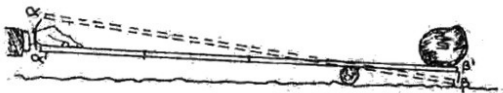
Figura 1.4. Si el brazo izquierdo de la palanca es tres veces más largo que el derecho, el movimiento del extremo izquierdo ( \alpha\alpha' ) es tres veces mayor que el movimiento del brazo derecho ( \beta\beta' ).
