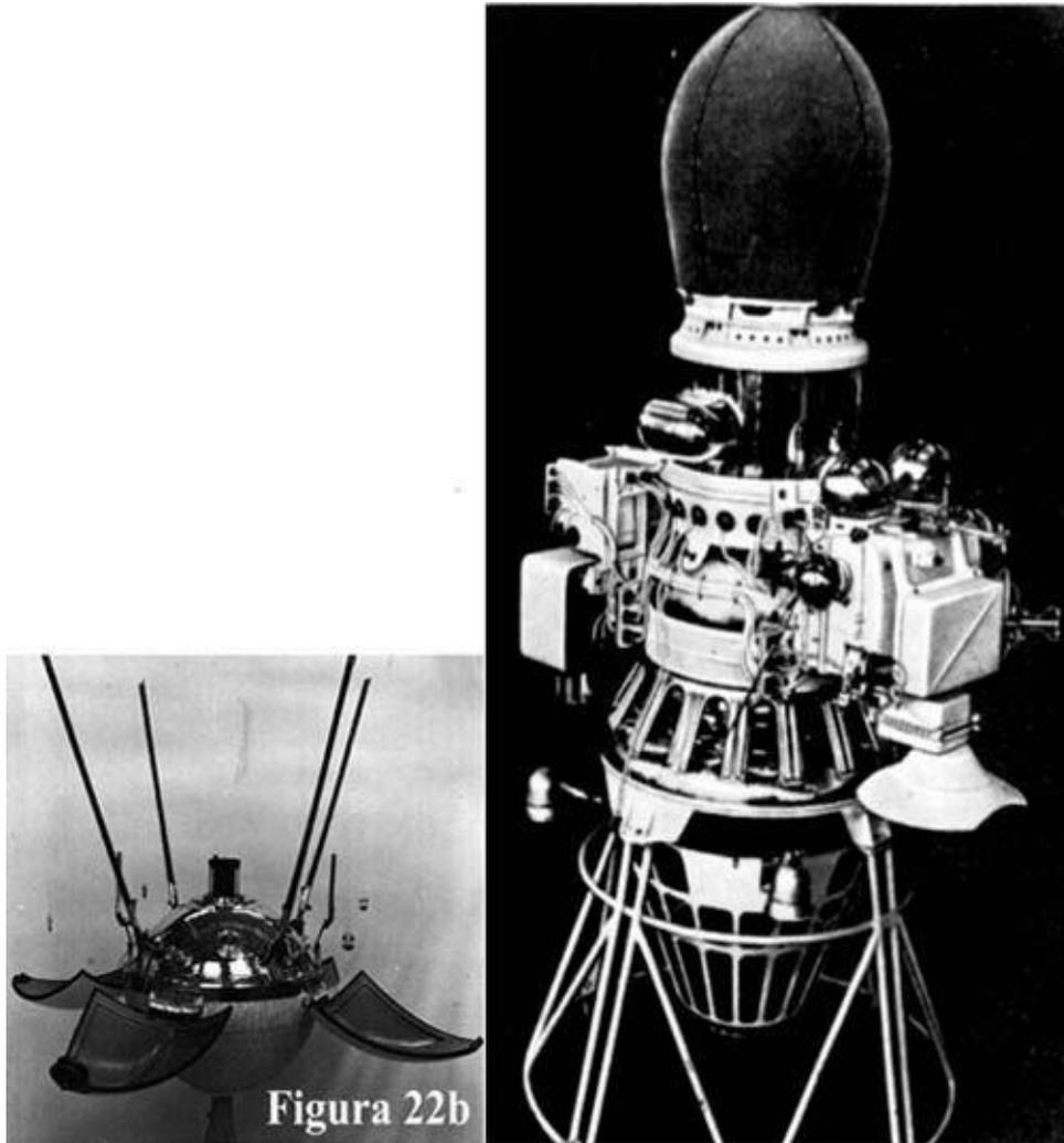
**Figura 22b. Cápsula:** Diámetro, 58 cm • Masa, 100 Kg Instrumentos, cámara de TV • espejo orientable.
