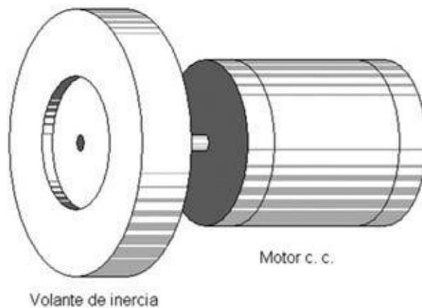
Los volantes de inercia son ruedas de gran masa concentrada en la periferia que giran con velocidad constante movidas por un motor eléctrico cuyo eje está acoplado con uno de los ejes ortogonales de un vehículo espacial. Cuando se las acelera ejercen reacción en sentido contrario sobre el vehículo, de modo que pueden corregir desviaciones muy finas. Se las emplea en grupos de tres, con los ejes formando un triedro trirectángulo.
