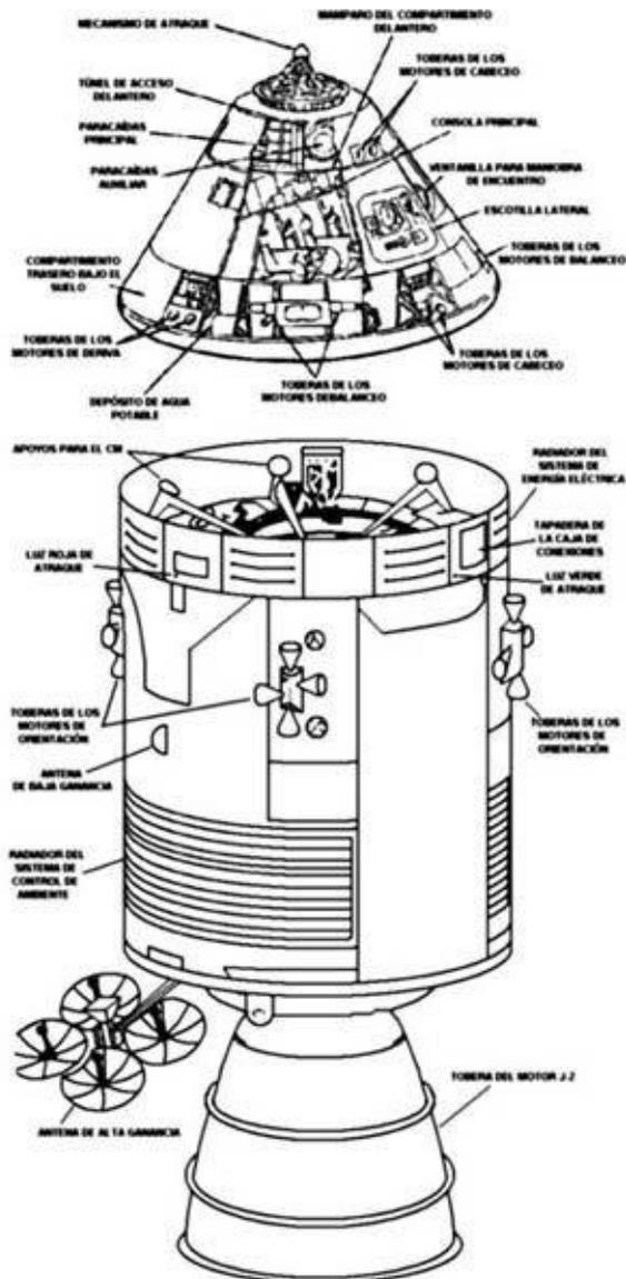
**Figura 39. Esquema del vehículo orbital Apollo (CSM).**
