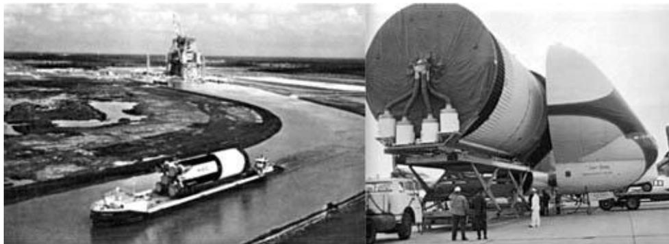
**Foto 41. Transporte de las etapas del lanzador *Saturn-5*.**
