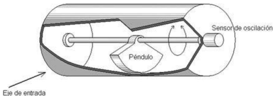
Un acelerómetro es un dispositivo capaz de detectar y medir cambios de velocidad, mediante la oscilación de una masa pendular. Como los giroscopios, los acelerómetros se montan acoplados a los ejes ortogonales del vehículo espacial, de modo que la oscilación del péndulo se produzca en
