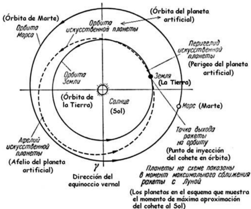
Figura 11. Esquema ruso de la órbita final de la sonda Lunik 1.
