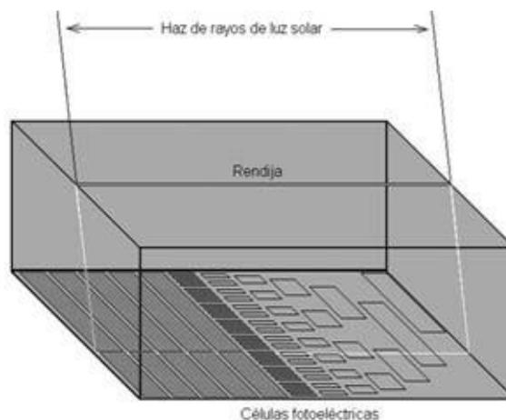
Un sensor de Sol es un dispositivo de orientación capaz de medir la inclinación de los rayos solares con respecto a los ejes de cabeceo o balanceo de un vehículo espacial. Consta de una cámara oscura en la que un haz de rayos solares penetra por una rendija e ilumina una disposición de células fotovoltaicas, dispuestas componiendo códigos digitales.
