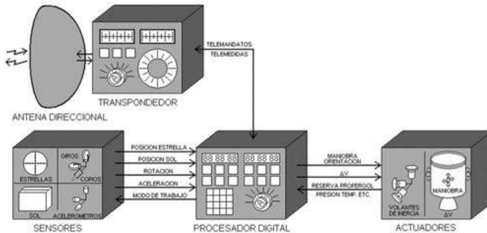
El flujo de la información es como sigue: el procesador digital recibe de la unidad de sensores dos tipos de información: de la orientación del vehículo en el espacio, tomada de los elementos rastreadores, el rastreador de estrellas y el sensor de Sol y del curso del vuelo, tomada de los giroscopios y acelerómetros. Esta información es también enviada a tierra con la corriente de telemidas.
