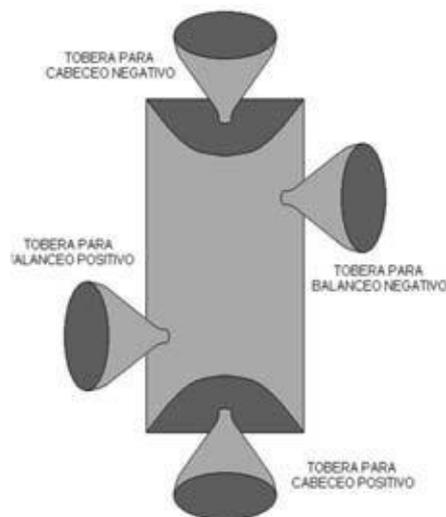
Los motores de maniobra de orientación suelen emplear hipergoles (hidracina) y funcionan emparejados utilizando toberas opuestas dispuestas sobre el fuselaje, acopladas a los ejes ortogonales del vehículo para producir movimientos de rotación sin afectar a la translación. Las toberas van montadas generalmente en grupos (de a cuatro) alimentadas por un mismo motor y orientadas de modo que puedan ejercer pares de fuerzas.
