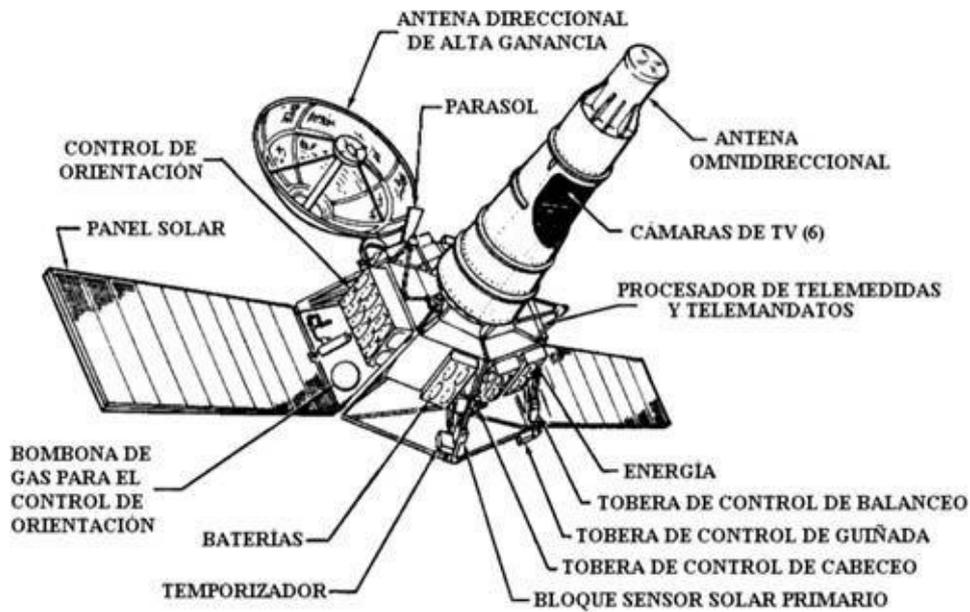
**Figura 17. Esquema de la sonda.**
