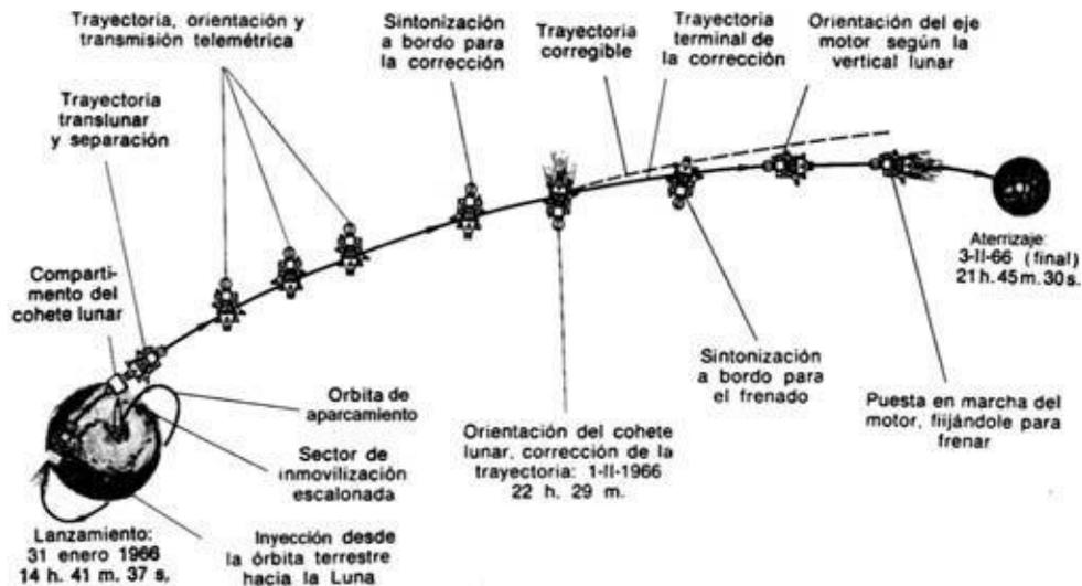
**Figura 24. Vuelo y maniobras de la sonda Luna-9.**
